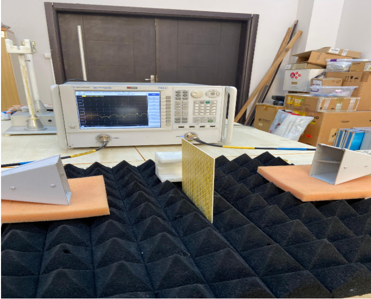
Şekil 15. FSY deney düzeneğine yerleştirilerek iletim katsayısı ölçümü
