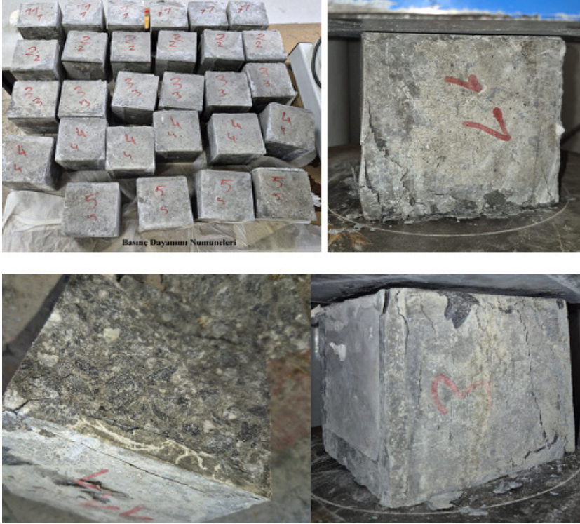
Şekil 2. Biyokütle Külü Katkılı Beton Gruplarına ait Deneysel Aşama Görüntüleri
