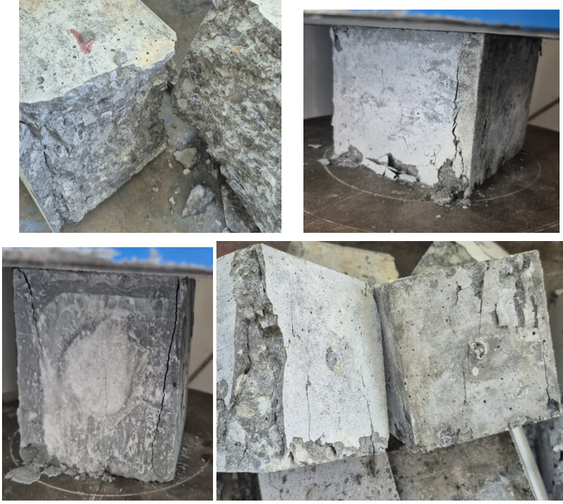
Şekil 4. Biyokütle Külü Katkılı Numune 28 ve 90 Basınç Dayanımı Sonrası Görüntüleri
