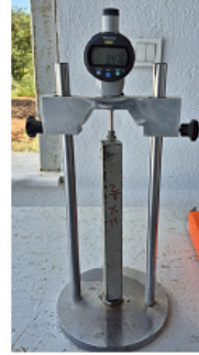
Şekil 2. Biyokütle Külü Katkılı Beton ve Harç Gruplarında ASR Oluşum Deneysel Aşama Görüntüleri
