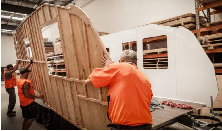
řekil 8. Standart ahřap duvar montajı
