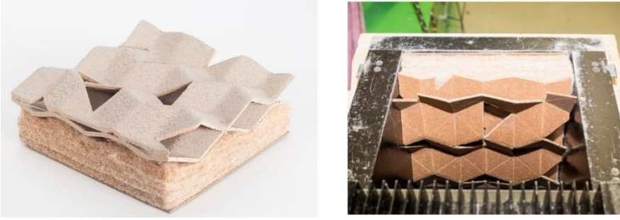
Şekil 8. NFRPC ile üretilen akustik emici panel (Dahy, 2019).
