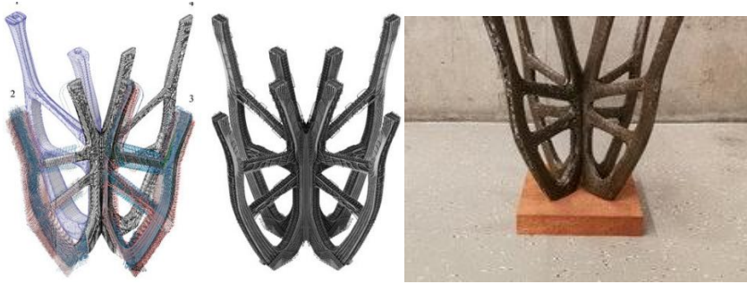
Şekil 3. Doğal elyaf takviyeli polimer kompozit ile tasarlanan ve gerçekleştirilen mimari çerçeve (Sippach vd., 2020).
