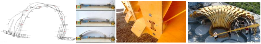
Şekil 5. 2010 pavyonunda kontrplak panellerin elastik bükülme süreci (ICD / ITKE Pavilion, t.y.)
