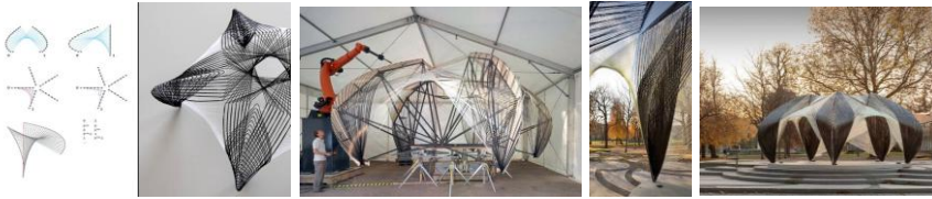
Şekil 4. 2012 pavyonunda fiber sarım örüntülerini gösteren yakın plan malzeme detayları (ICD / ITKE Pavilion, t.y.)
