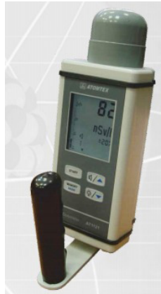
Şekil 2. Atomtex AT1121 sintilasyon gama dedektörü
