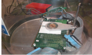
Őekil 9: Kalp BoŐluđunun Üstünde Cf-252 Kaynak YerleŐimi (Makris vd., 2009:36)
