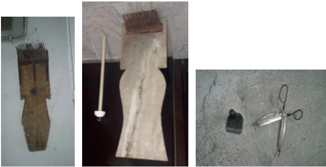
Şekil 1: “şe” yün tarakları- “taşı” yün eğirme(ip büküm) aleti- “hapi” demir kirkit ve ilme makası
