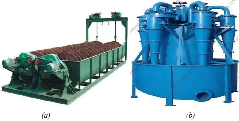
Şekil 6. Spiral Klasifikatör (a) ve Hidrosiklon (b) [10, 11]
