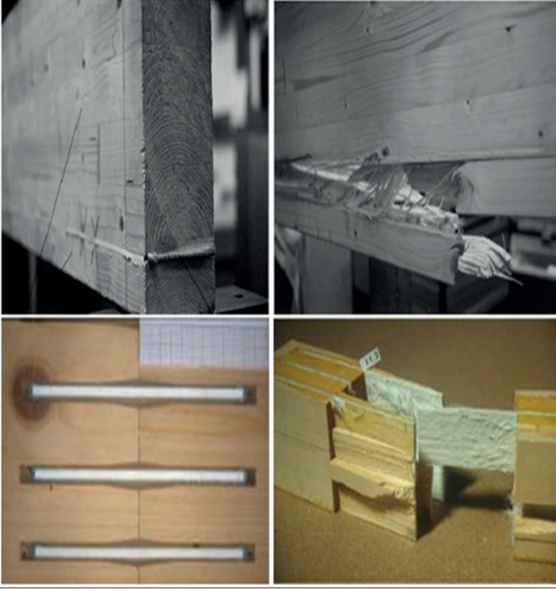
Şekil 8. Eğilme deneyine tabi tutulan FRP’lerle güçlendirilmiş deney numuneleri
