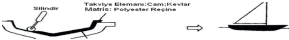
Şekil 1. El yatırma düzeneği.
