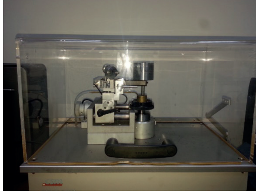
Şekil 2. CSM Tiribometer Aşınma Cihazı
