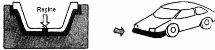
Şekil 3. Reçine transfer kalıplama düzeneği.
