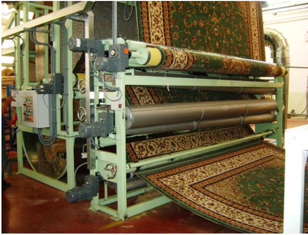
Şekil 5. Toz temizleme bölümü
