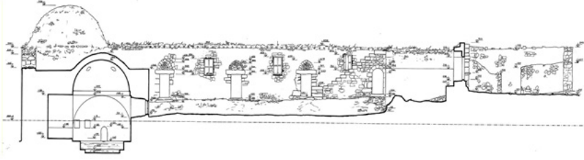
Şekil 25. Önge tarafından 1971 yılında hazırlanan ılıca havuzundan geçen, avludan doğu cephesini de gösteren rölöve kesitinin görünüşü (Kayseri Vakıflar Bölge Müdürlüğü arşivi)
