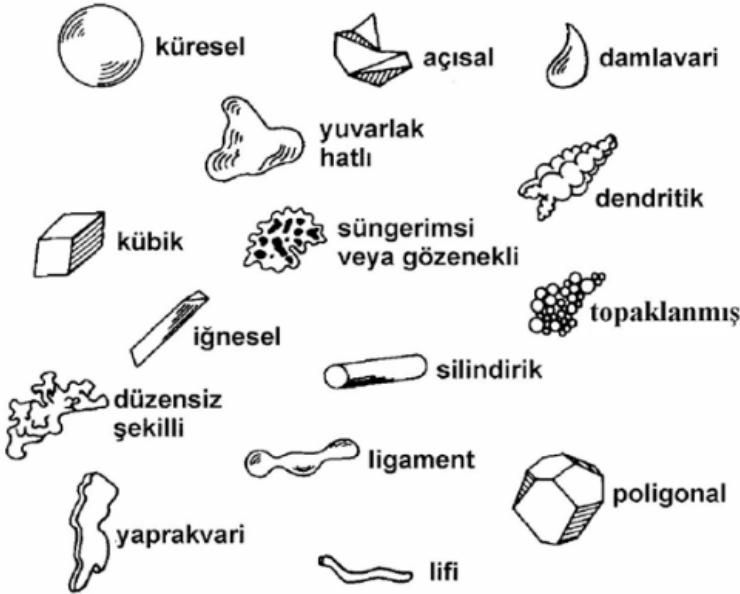
Şekil 5. Çeşitli üretim teknikleriyle üretilmiş toz şekilleri (Karagöz, Yamanoğlu, & Atapek, 2009)
