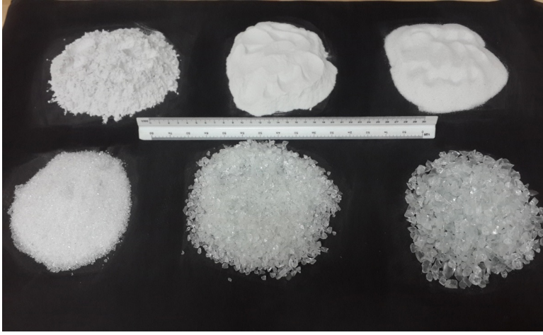
Şekil 3: Öğütme sonrası elenen camlardan görüntü (İskender, 2017)
