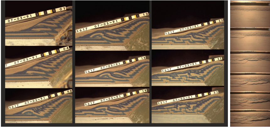
Şekil 1.3. Bindirme tektoniğindeki kıvrım ve önemli incelme gelişiminin kum kutusu deneylerindeki aşamalı kesit ve üstten görünümü (Nieuwland, 1997).
