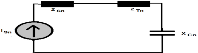
Şekil 15 Güç sisteminin n harmonikteki eşdeğer devresi
