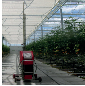
Şekil 7. Isıtma boruları veya raylar üzerinde hareket eden kendi yürür dikey püskürtme sistemine sahip ilaçlama makinaları (Anonim, 2024gh)
