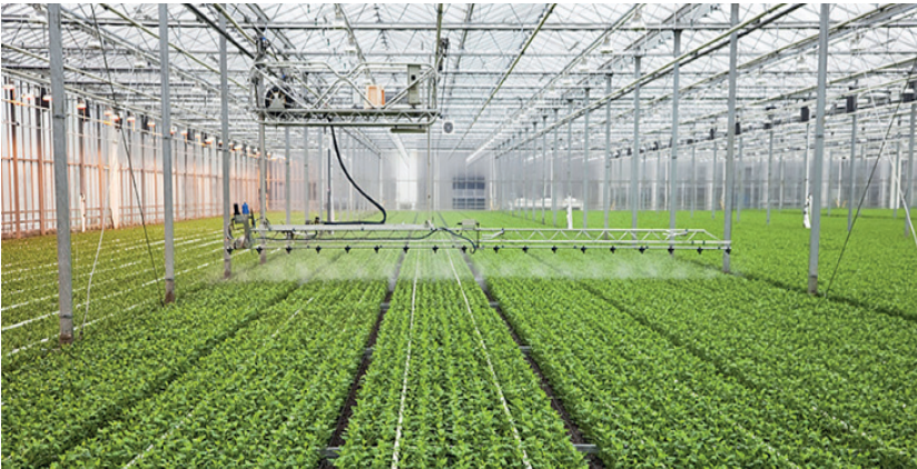
řekil 9. Sulama ve ilaçlama için kullanılabilen püskürtme sistemi (Anonim, 2024i)
