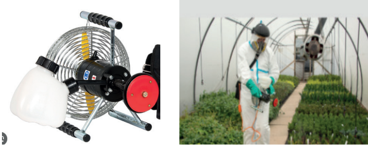
Şekil 5. Elde taşınan yardımcı hava akımlı döner diskli pülverizatör (Anonim, 2024f)
