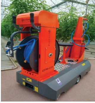
Şekil 7. Isıtma boruları veya raylar üzerinde hareket eden kendi yürür dikey püskürtme sistemine sahip ilaçlama makinaları (Anonim, 2024gh)
