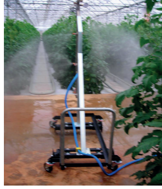
Şekil 7. Sera zemininde ısıtma boruları üzerinde veya sıra aralarında elle çekilir tip dikey püskürtme sistemine sahip ilaçlama sistemi (Anonim, 2024g)
