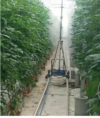
Şekil 7. Sera zemininde ısıtma boruları üzerinde veya sıra aralarında elle çekilir tip dikey püskürtme sistemine sahip ilaçlama sistemi (Anonim, 2024g)
