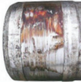
Şekil 5. Korozif aşınma görüntüsü [4]
