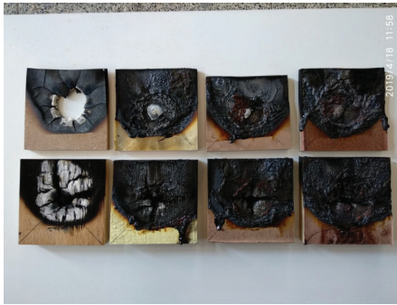
Şekil 7. Fe 2 O 3 katkılı poliüretan kaplı ahşap kompozit malzemelerin yanma davranışları
