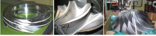
Şekil 13. Lazer kaplama örnekleri [21]
