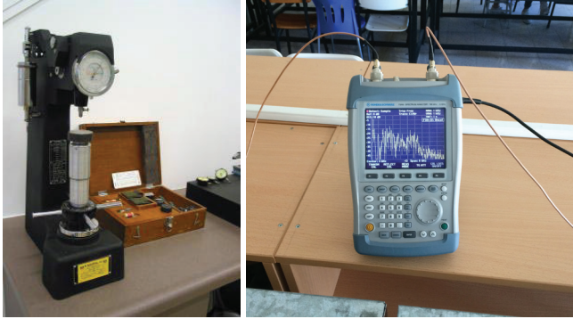
Şekil 4. (a) Sertlik ölçme cihazı (Misawa Seiki Hardness Tester), (b) Elektromanyetik kalkanlama etkinliği ölçüm cihazı (Rohde & Schwarz Spectrum Analyzer)
