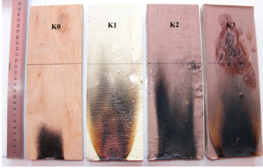
Şekil 5. Ahşap kompozit malzemelerin tek alev kaynaklı yanma testi
