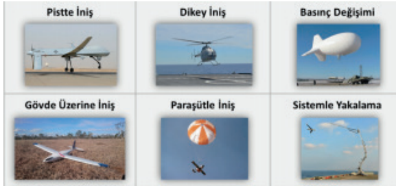
Şekil 3: İniş/Kurtarma Yöntemine Göre İHA Türleri
