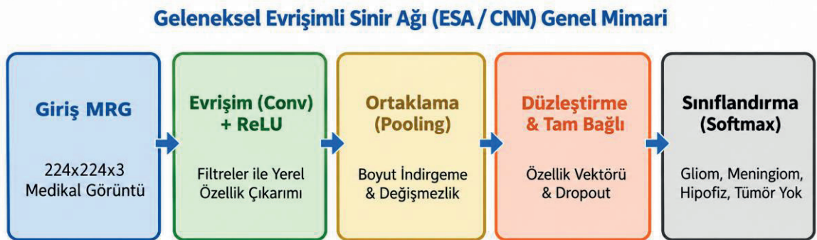
Şekil 4. Evrişimli Sinir Ağı (ESA / CNN) temel katman ve sınıflandırma genel mimarisi
