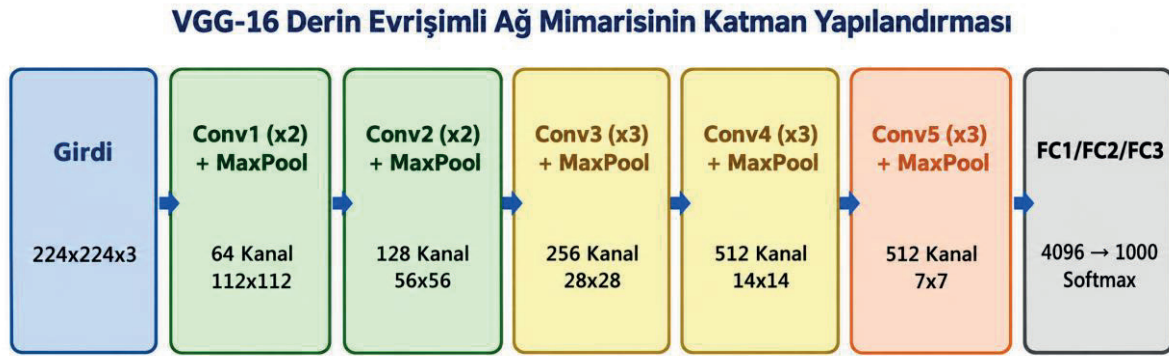
Şekil 5. VGG-16 derin evrişimli ağ mimarisinin detaylı katman yapılandırması
