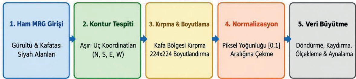
Şekil 7. Tıbbi beyin MR görüntülerinde kontur tespiti, kırpma, boyutlandırma ve ön işleme adımları
