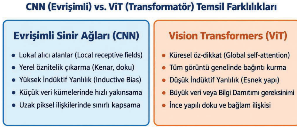
Şekil 1. Evrişimli Sinir Ağları (CNN) ile Vision Transformer (ViT) mimarilerinin temsil özelliklerinin karşılaştırılması
