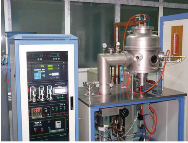
Şekil 3.9 Bridgman katılaşma ekipmanının fotoğrafı [6]
