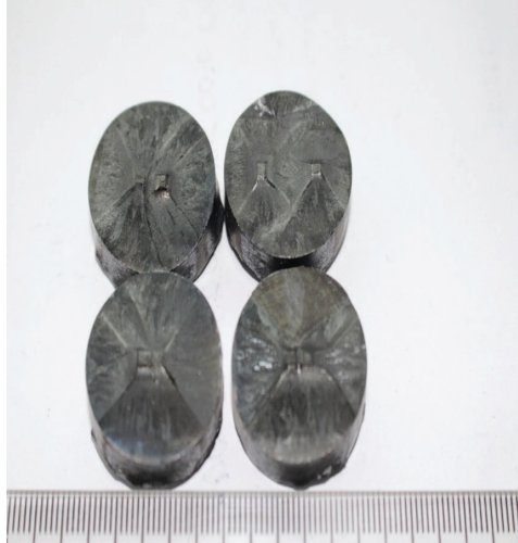
Şekil 4. Isıl işlem sonrası d = 0, 1, 4 ve 12 mm uzaklığındaki çoklu kristal yapıdaki YBCO süperiletkenlerin üst yüzeylerinin fotoğrafları.
