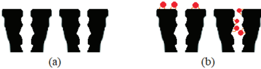
Şekil 1. Kirlenmemiş (Temiz) membran (a) ve adsorpsiyon formunda kirlenmiş membran (b) yapılarının şematik gösterimi.
