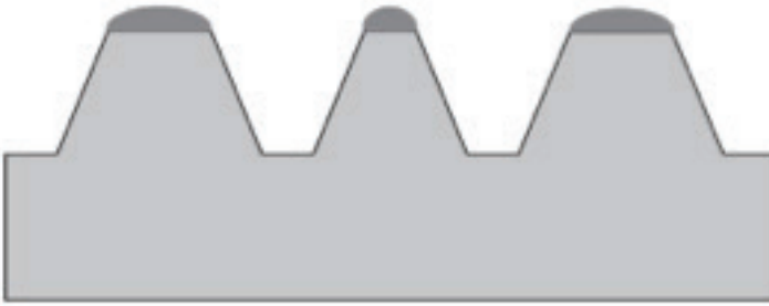
Şekil 3. İndirilmiş flekso baskı kalıbı (Mürekkep veren kısımlar koyu olarak gösterilmiştir)
