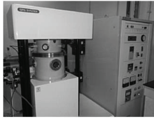
Şekil 3.14. (a) Kıvılcım plazma sinterleme (SPS) kurulumunun şematiği ve (b) IIT Kanpur'daki SPS tesisinin fotoğrafı [14]
