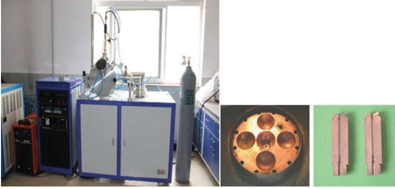
Şekil 3.5. Ark ertitme ve döküm ekipmanının fotoğrafı (sağdaki ikisi bakır pota ve bakır kalıptır) [6]
