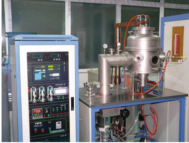
Şekil 3.9 Bridgman katılaşma ekipmanının fotoğrafı [6]
