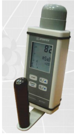
Şekil 2. Atomtex AT1121 sintilasyon gama dedektörü
