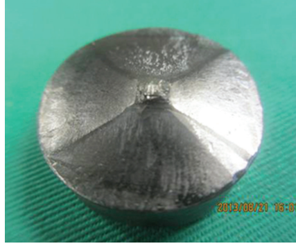
Şekil 10. IG yöntemiyle üretilen REBCO örneğinin üstten görünümü [43].
