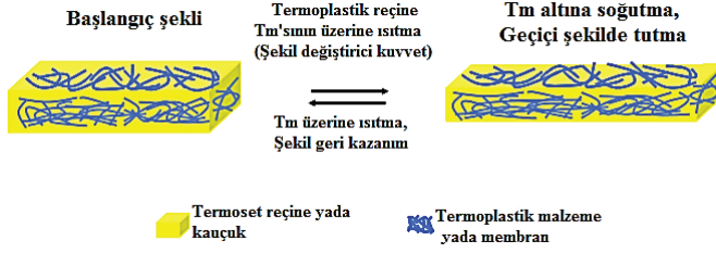
Şekil 1. Termoset reçine/kauçuk ve termoplastik membrandan oluşan şekil hafızalı işlemin şematik gösterimi.
