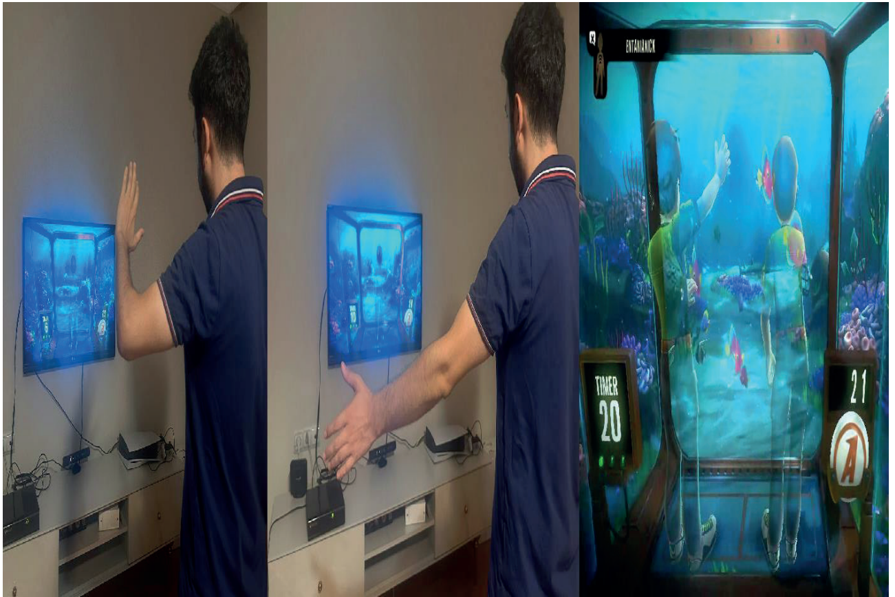
Şekil 1. Xbox 360 Kinect kamera sistemi kullanılarak gerçekteřtirilen sanal gerçeklik tabanlı rehabilitasyon uygulamasına örnek.
