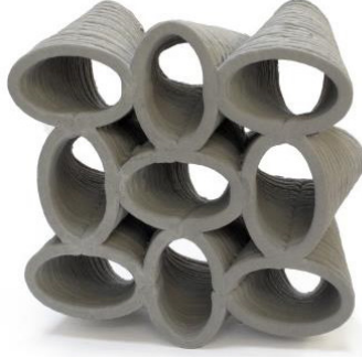
Şekil 3. 3D baskı beton ile üretilmiş duvar [16].
