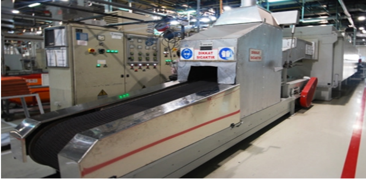
Şekil 12. Sinterleme fırını (Konveyörlü-bantlı sistem)
