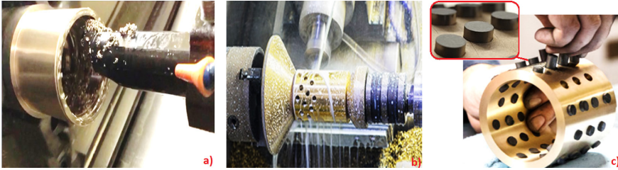
Şekil 14. Katı yağlayıcı gömülmüş kaymalı yatak üretim süreci:
