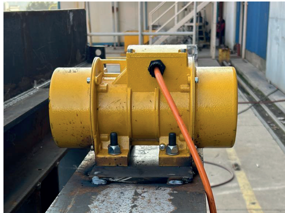
Şekil-1: Endüstriyel tip bir titreşim motoru
