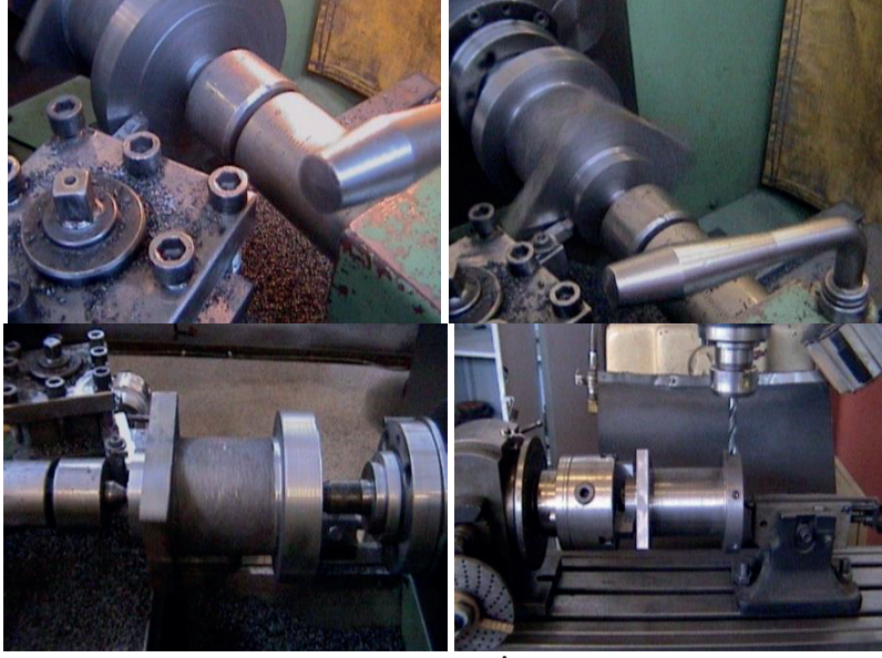
Şekil 10. Silindirin Bazı İmalat Aşamaları.
