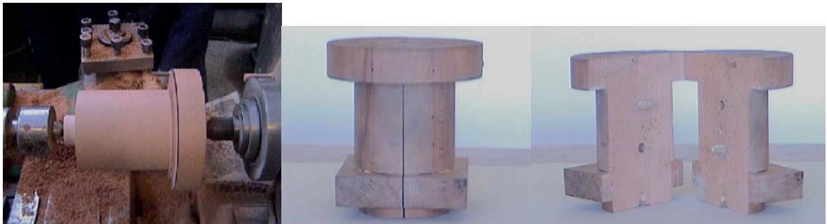
Şekil 9. Silindir Modelinin İmalat Aşaması ve Modelinin Son Şekli.
