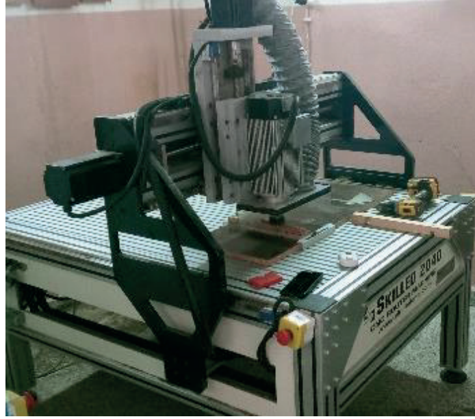
Şekil 3. Skilled 2040 CNC takım tezgahı
