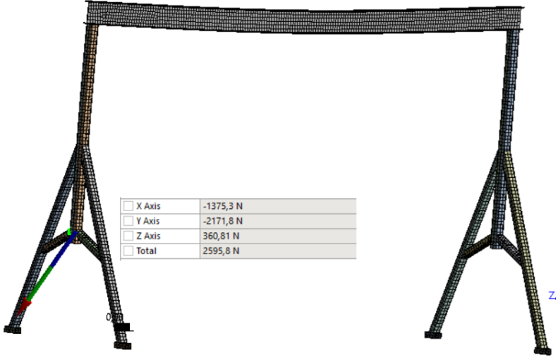
Şekil 7 Temas noktasındaki tepki kuvveti ve sonlu elemanlar programında gösterilişi
