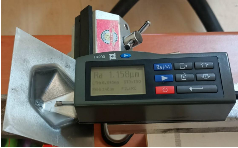
Şekil 2.6 TR-200 (3200) Deney Numunesinin Yüzey Pürüzlülük Ölçüm Cihazı ile Ölçüm Anı
