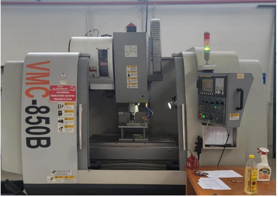
Şekil 2.2 Artımlı Şekillendirme Operasyonunda Kullanılan CNC Dik İşleme Merkezi
