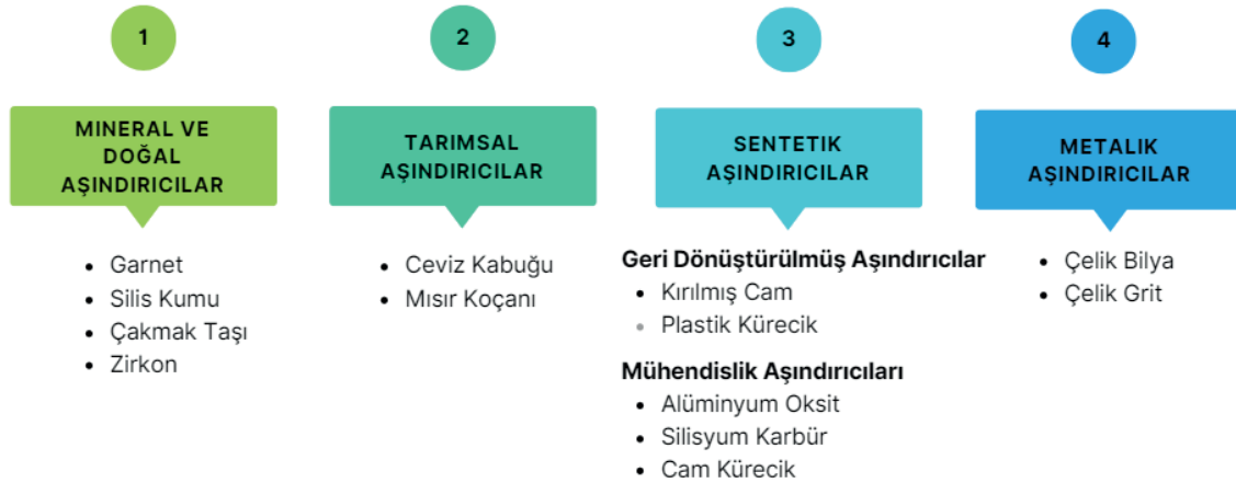
Şekil 1. Kumlama İşleminde Kullanılan Aşındırıcıların Sınıflandırılması [8]
