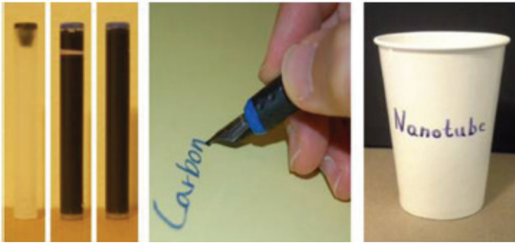
Şekil 4. Karbon nanotüp içerikli mürekkep ve kalemle devre çizimi (Han, Beomseok Kim, & Meyyappan, 2014)
