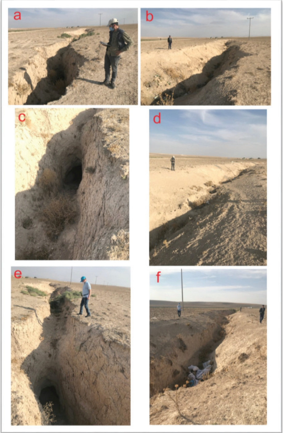
Şekil 6. Menekirsesi Obruğu kuzeydoğusunda toplamda 150 m uzunluğundaki yüzey yarıklarının arazi görünümü
