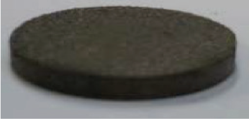
Şekil 2. Presleme Sonucu Elde Edilen Tablet Numune
