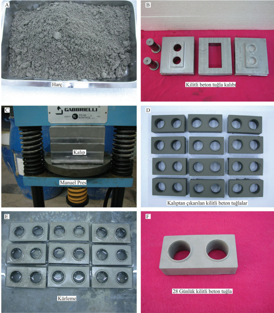
Şekil 7. Kilitli beton tuğla üretim aşamaları. (A) granit çamuru, çimento ve su ile hazırlanmış harç (B) Tasarlanan çok parçalı kalıp (C) manuel kontrollü pres (D) Sıkıştırılmış ve kalıptan çıkarılmış taze kilitli beton tuğlalar (E) Kırleme işlemi, (F) 28 günlük kilitli beton tuğlalar.
