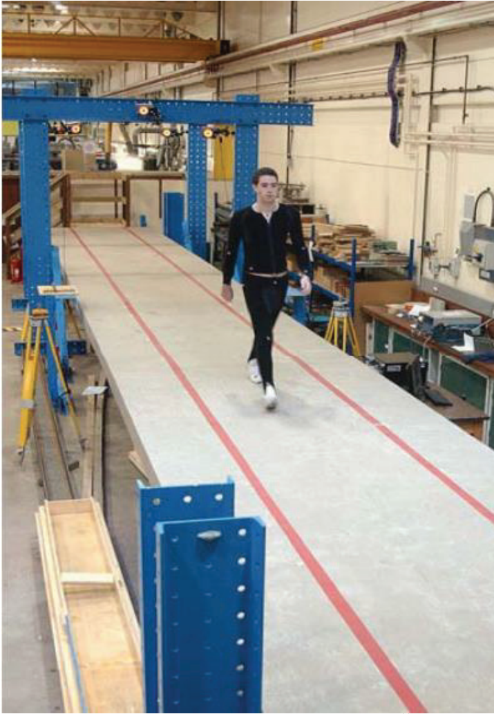
Şekil 4: Warwick Üniversitesi prototip yaya köprüsü (Živanovic, 2012)
