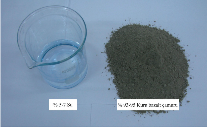
Şekil 5. Kilitli tuğla üretiminde kullanılan malzemeler ve karışım oranları.
