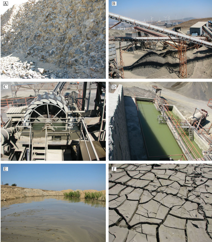
Şekil 2. (A) Agregası üretilen bazalt yüzleđi, (B) Kırma eleme tesisi, (C) Agregası yıkama tesisi (D) Çamur çökeltme havuzu, (E) Bazalt çamur depolama havuzu (F) Bazalt çamuru.
