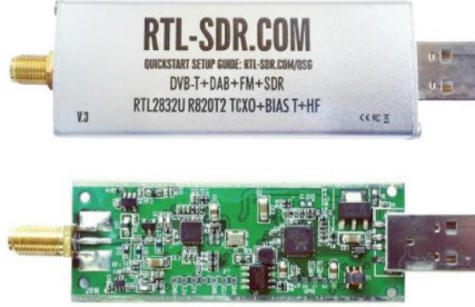
Şekil 4. RTL2832U yazılım tabanlı radyo uygulaması
