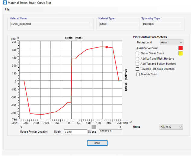
Şekil 3. Çelik Malzemesinin Gerilme Şekil Değiştirme Eğrisi.
