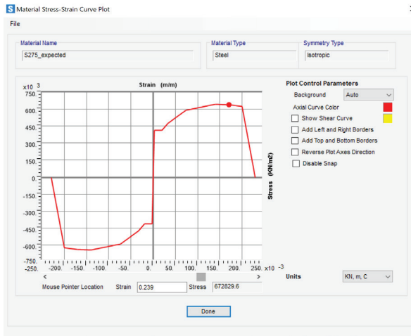
Şekil 3. Çelik Malzemesinin Gerilme Şekil Değiştirme Eğrisi.
