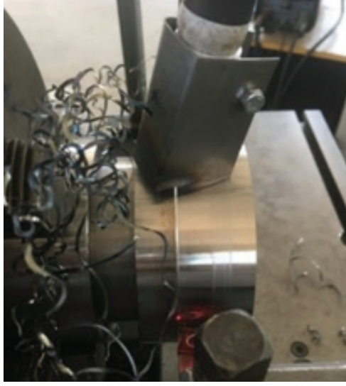
Şekil 16. Yüksek ısı nedeniyle talaş düzleşmesi
