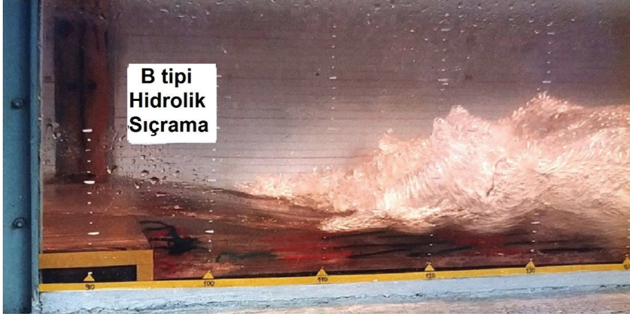
Şekil 5. Ani Taban Düşülerinde B Tipi Hidrolik Sıçrama
