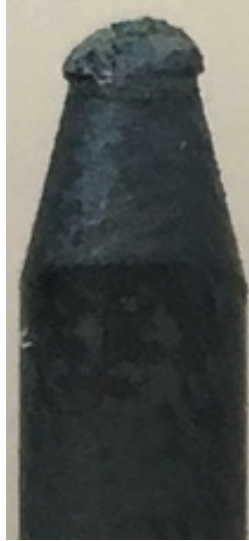
Şekil 17. Kısa devre nedeniyle bozulan elektrot ucu
