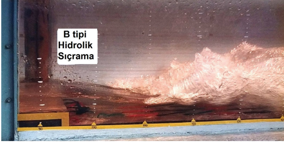
Şekil 5. Ani Taban Düşülerinde B Tipi Hidrolik Sıçrama
