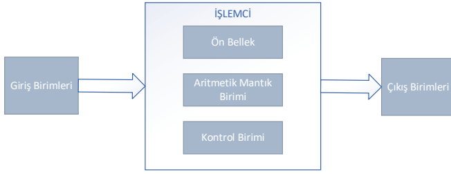
Şekil 3. Aritmetik Mantık Ünitesi mimarisi blok diyagramı.
