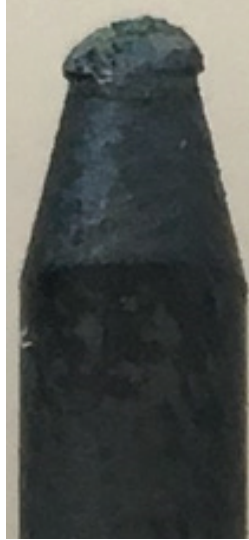
Şekil 17. Kısa devre nedeniyle bozulan elektrot ucu
