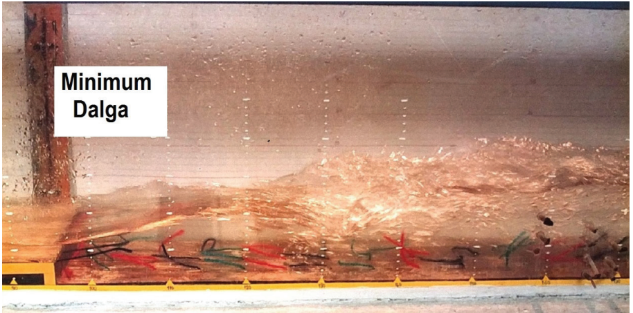
Şekil 7. Ani Taban Düşülerindeki Yukarı Yönlü Jet (Minimum Dalga)
