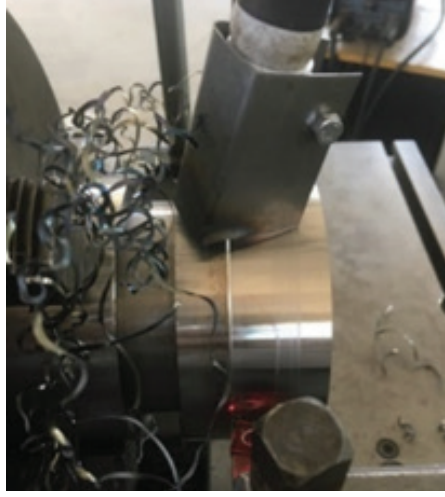
Şekil 16. Yüksek ısı nedeniyle talaş düzleşmesi
