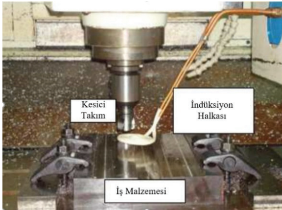
Şekil 6. İndüksiyon akımı ile frezeleme (Lajis vd., 2009)
