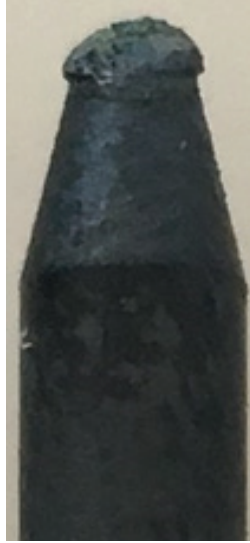
Şekil 17. Kısa devre nedeniyle bozulan elektrot ucu
