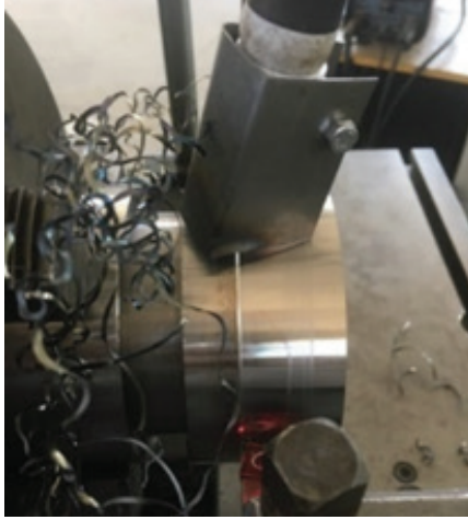
Şekil 16. Yüksek ısı nedeniyle talaş düzleşmesi
