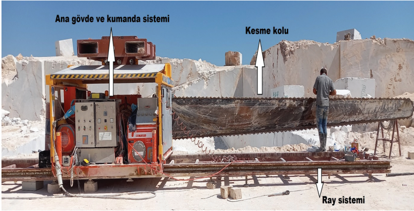
Şekil 5. Fantini 70 SUPER-H zincirli kesme makinesinin temel üniteleri (Candemir, 2021)
