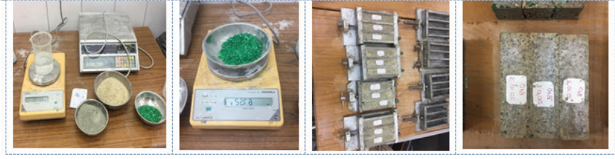
Şekil 2. Harçların üretim aşaması.
