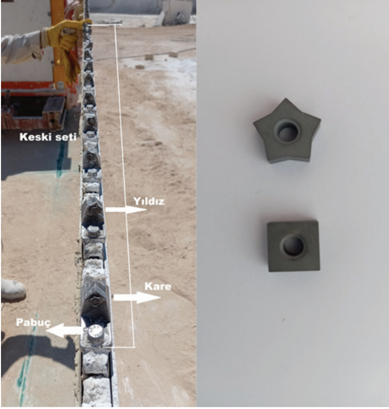
Şekil 6. Bir zincirli kesme makinesinde kullanılan keski seti ve keski seti görünüşü (Candemir, 2021)
