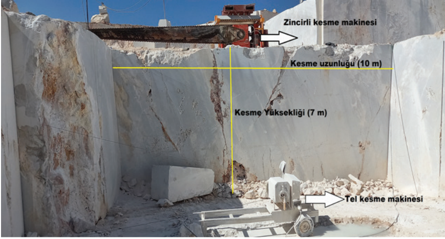
Şekil 4. Fantini 70 SUPER-H zincirli kesme makinesi ile bir doğal taş ocağında kesilen bir basamak görünümü (Candemir, 2021)
