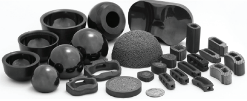
Şekil 8 Artroplasti ve spinal uygulamaları için Si_3N_4 ürün örnekleri Amedica Corp. (Bal & Rahaman, 2012)
