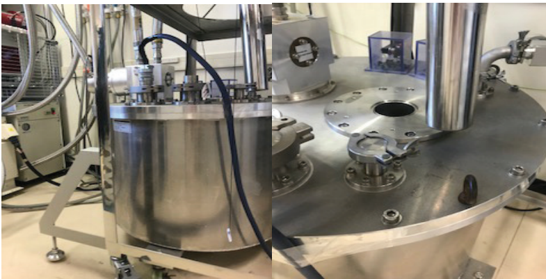
Şekil 6. Tokyo Üniversitesi (TUAT) Uygulamalı Fizik Bölümü, 5 T düşük sıcaklık süperiletken solenoid mıknatıs sistemi.
