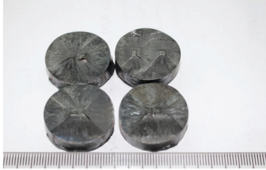
Şekil 4. Çoklu Çekirdeklerin (100) // (001) Yapıda Olduğu YBCO Süperiletken Peletlerinin Hazırlanışı. Isıl işlem sonrası d = 0, 1, 4 ve 12 mm uzaklığındaki çoklu kristal yapıdaki YBCO süperiletkenlerin üst yüzeylerinin fotoğrafları.
