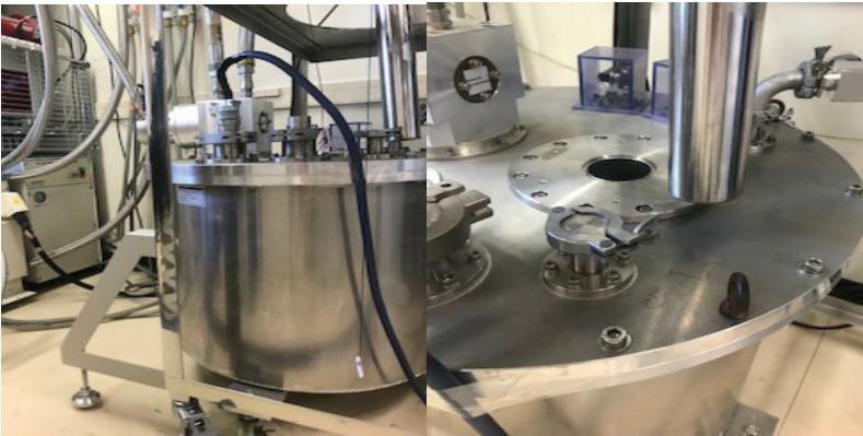
Şekil 6. Tokyo Üniversitesi (TUAT) Uygulamalı Fizik Bölümü, 5 T düşük sıcaklık süperiletken solenoid mıknatıs sistemi.
