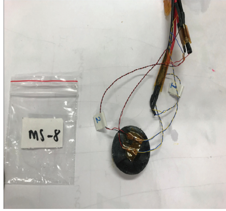
Şekil 5. İki Lakeshore Hall sensörü (H1 ve H2) örnek yüzeyinin merkezinden radyal yönde 0 ve 6 mm konumlarında üst yüzeyin ortasına yerleştirildi.
