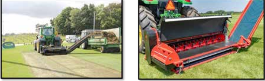
Şekil 2.12. Hibrit sistemli futbol sahalarında kullanılan sıyırma ekipmanları (Pass, 2015; URL-12)
