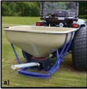
Şekil 2.11. Hibrit sistemli futbol sahalarında kullanılan gübreleme ekipmanları a) Gübre serpmek için kullanılan URL-11 b) Pülverizatör
