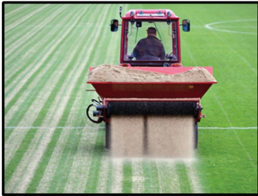
Şekil 2.4. Hibrit sistemli futbol sahalarında kullanılan kumlama ekipmanları (URL-3; URL-4)
