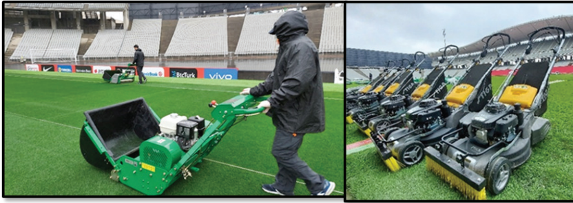
Şekil 2.1. Hibrit sistemli futbol sahalarında kullanılan silindirik ve döner bıçaklı çim biçme ekipmanları
