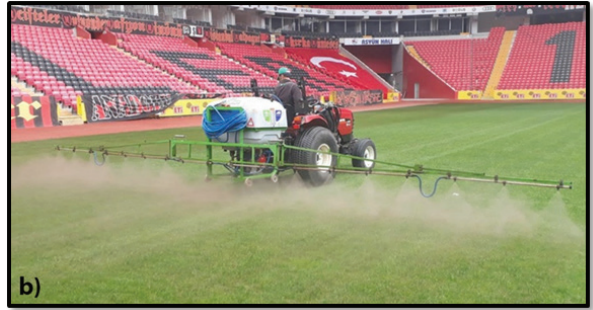
Şekil 2.11. Hibrit sistemli futbol sahalarında kullanılan gübreleme ekipmanları a) Gübre serpmeye ekipmanı (URL-11) b) Pülverizatör
