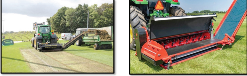
Şekil 2.12. Hibrit sistemli futbol sahalarında kullanılan sıyırma ekipmanları (Pass, 2015; URL-12)
