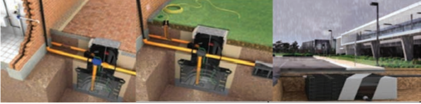
Şekil 11. Yağmur suyu infiltrasyon hazneleri uygulama örnekleri (Demir, 2012)
