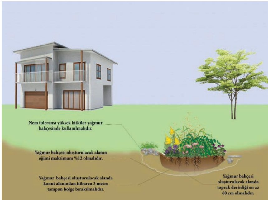
Şekil 8. Konut alanında yağmur bahçesi tasarımında dikkat edilmesi gerekenler (Müftüoğlu ve Perçin, 2015'den yararlanılarak şematize edilmiştir.)
