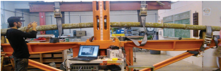
Şekil 22. Bambular için eğilme dayanımı testi (URL-24, 2020).
