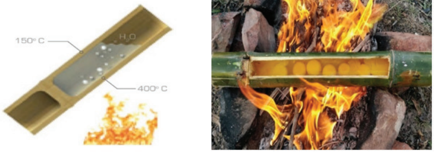
Şekil 23. Bambunun ısıya dayanımı (Nowak ve Ansari, 2013, URL-25, 2019).
