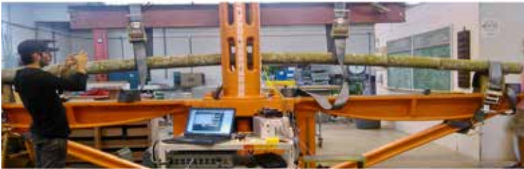
Şekil 22. Bambular için eğilme dayanımı testi (URL-24, 2020).
