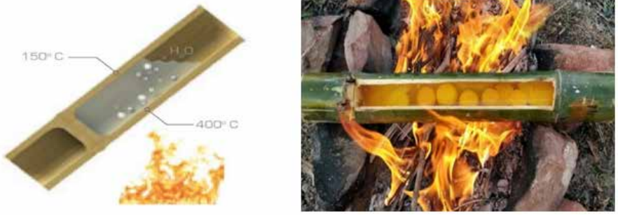
Şekil 23. Bambunun ısıya dayanımı (Nowak ve Ansari, 2013, URL-25, 2019).
