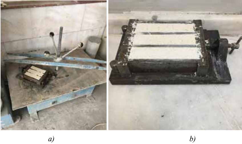
Şekil 4. a) Harç Numunelerinin Sarsma Tablasındaki Görünümü b) Üretilen Harç Numunesine Ait Görünüm.
