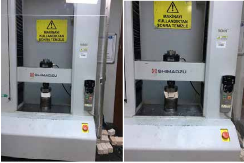
Şekil 7. Basınç Dayanımı Deneyinin Yapılışı.
