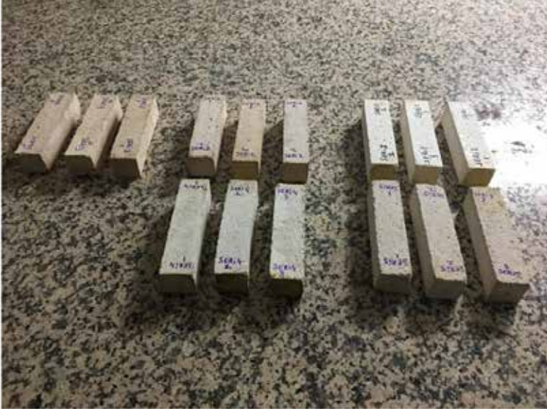
Şekil 2. Harç numunelerine ait görünüm.
