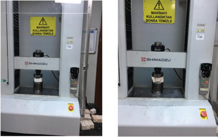
a) b) Şekil 7. Basınç Dayanımı Deneyinin Yapılışı.
