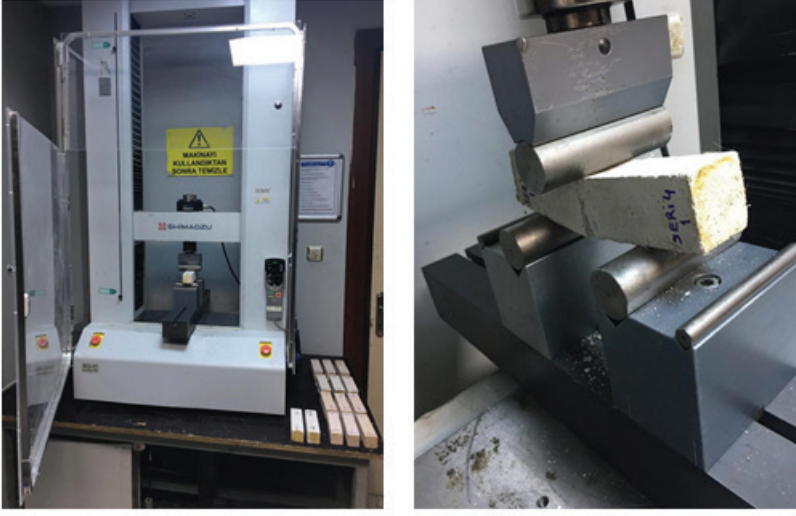
a) b) Şekil 5. (a)-(b) Eğilme Dayanımı Deneyinin Yapılışı.
