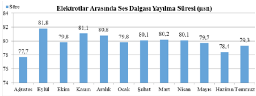
Şekil 15. Deva Hamamı Ağustos 2016-Temmuz 2017 tarihleri arasındaki elektrotlar arası ses dalgası yayılma süresi değişim grafiği
