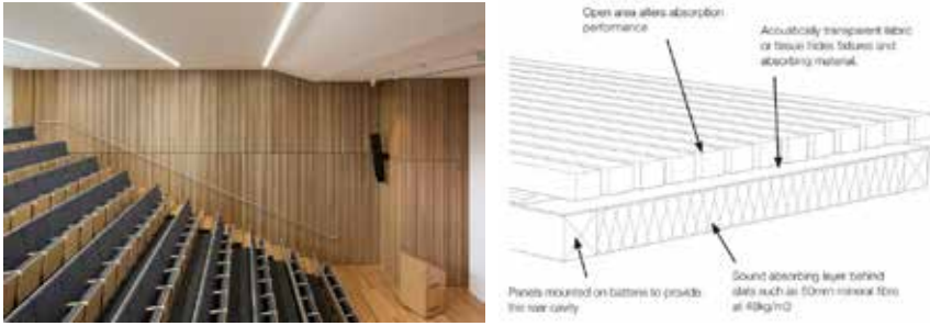
Şekil 10. Boşluklu rezonatör olarak ahşap latanın kullanılması (Url-1)
